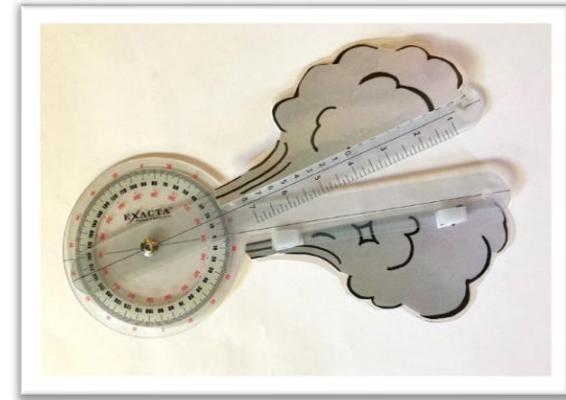
Klipp ut, Laminer og monter på gnoiometeret med borrelås, en på baksiden av gnoiometeret og en på forsiden.
